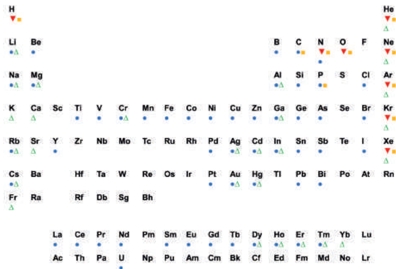
Рис. 1. Химические элементы, применяемые в источниках ионов разных типов: ■ — на основе газовой плазмы [5, 6, 10–16], ▼ — газовые автоионные источники [6–8, 17–22], • — электрогидродинамические [2–4, 23], Δ — с магнитооптической ловушкой [9].
