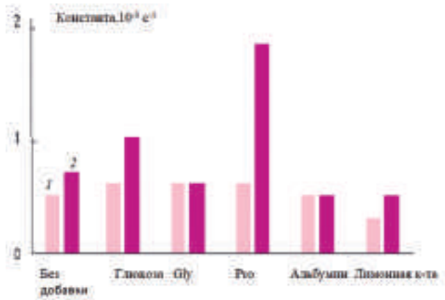
Рис. 3. Константы кристаллизации для минимальных концентраций различных добавок при пересыщении S (участок 2): минимальном 1.5 (1), максимальном 2.5 (2).
