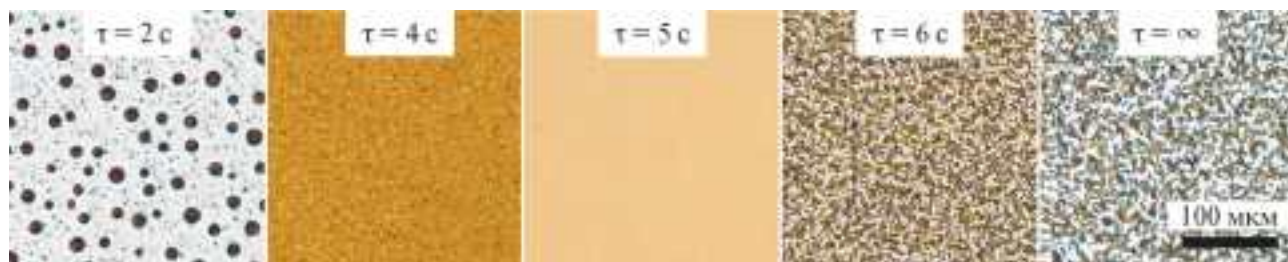
Рис. 2. Оптические изображения пленок \text{MAPbBr}_3 , приготовленных при скорости вращения центрифуги 4400 об./мин, температуре 22°C и различном времени внесения антирастворителя \tau = 2, 4, 5, 6 с и \infty (антирастворитель не добавлялся).
