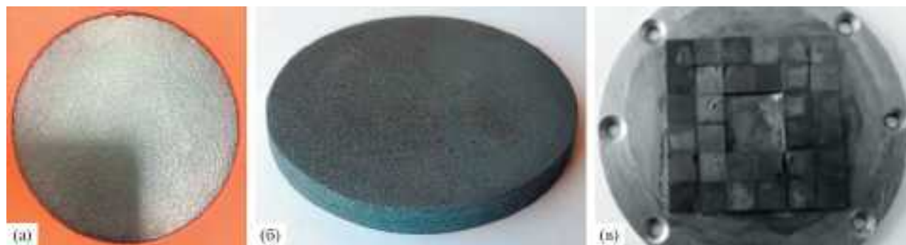
Рис. 1. Внешний вид ВСМ-мишеней 1–3 (а–в).
