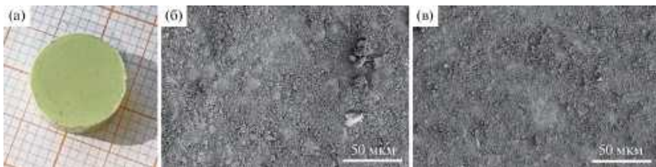
Рис. 4. Внешний вид поликристаллического образца (а) и СЭМ-изображение участков поверхности керамик, полученных из частиц \text{Pr}_{0.97}\text{Sr}_{0.03}\text{F}_{2.97} после \tau = 1 (б) и 4 ч (в) помола.
