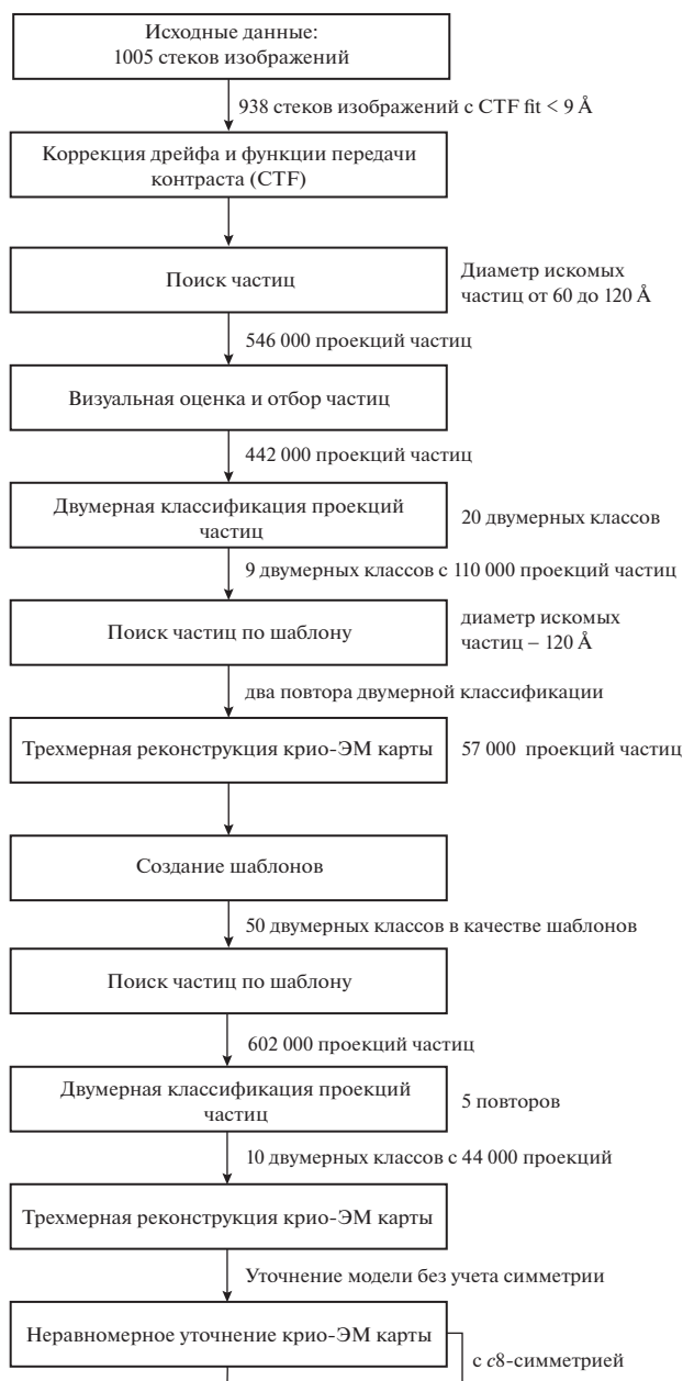
Рис 1. Основные этапы обработки крио-ЭМ-данных каротиноидсодержащего светособирающего комплекса LH2+ из пурпурной серной бактерии Ectothiorhodospira haloalkaliphila .
