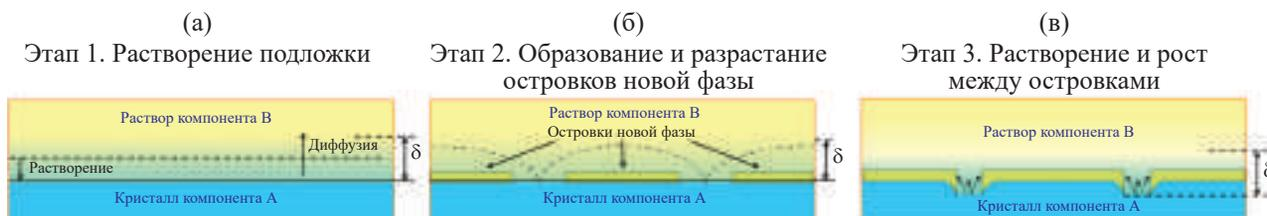
Рис. 4. Этапы формирования эпитаксиальных структур: а – начальное растворение подложки, б – осаждение островков, в – дальнейший рост островков в процессе растворения подложки [57].
