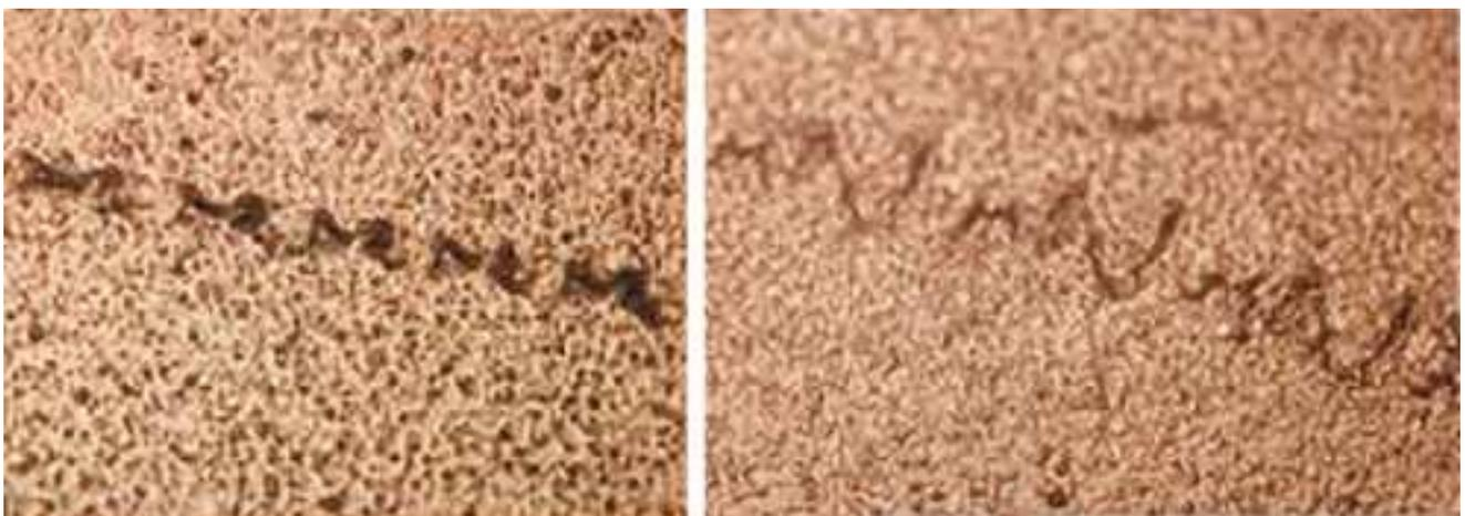
Рис. 4. Треки, образовавшиеся на фотопленке, обернутой вокруг цилиндрического образца: а – образец из алюминия ( $\times 500$ ), б – образец из стали ( $\times 600$ ).
