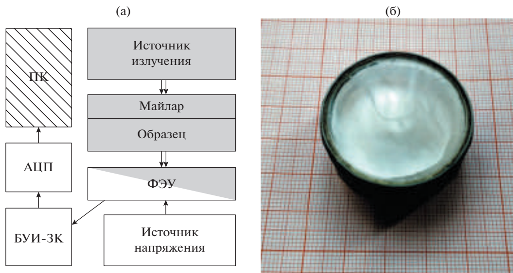
Рис. 1. Схема установки для исследования световыхода (а) и сцинтилляционный детектор на основе монокристалла стильбена (“эталон 1”) (б).
